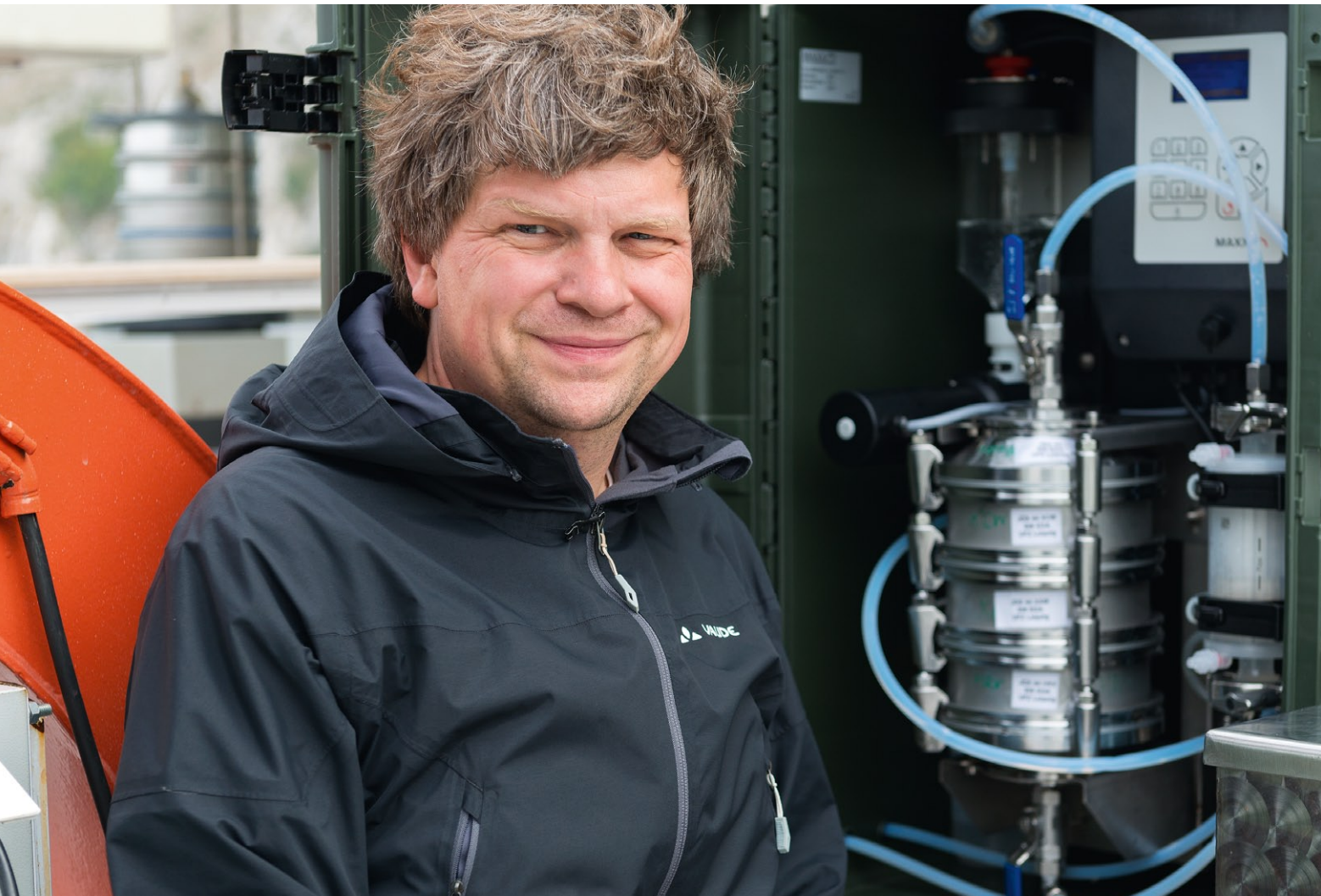
Der Umwelttoxikologe Dr. Tobias Schulze nutzt an Bord des Forschungsschiffes ein am UFZ entwickeltes Probenahme-Gerät. Es dient dazu, die gelösten Bestandteile aus dem Wasser für eine spätere chemische und ökotoxikologische Analyse zu extrahieren – und erspart damit den aufwendigen Transport von großvolumigen Wasserbehältern nach Deutschland. Zunächst wird das Wasser mithilfe einer Durchlaufzentrifuge von seinen Schwebstoffen befreit. Danach werden die im Wasser gelösten organischen Schadstoffe auf speziellen Polymeren gebunden, die sich in Kartuschen aus Edelstahl befinden. Ist eine der Kartuschen voll, wird sie gewechselt, entsprechend gekennzeichnet und bis zur Analyse im Heimatlabor deponiert. (Foto: André Künzelmann, UFZ)
