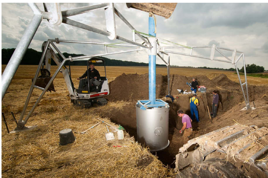
Entnahme eines Lysimeters in der Magdeburger Börde. Um den Einfluss von Klimaänderungen auf den Wasser- und Stoffhaushalt von Böden zu untersuchen, wurden viele solcher Bodenmonolithe im Austausch gegen andere in klimatisch unterschiedliche Standorte Deutschlands verfrachtet. (Foto: André Künzelmann/UFZ)
